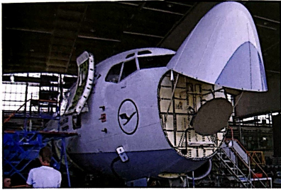
Hình 7. Ở phần mũi của các máy bay đều có trang bị hệ thống radar thời tiết. Radar này là kết hợp của radar xung và radar Doppler. Thời gian phản xạ của các xung điện từ được sử dụng để đo khoảng cách còn hiệu ứng Doppler được sử dụng để đo vận tốc. Nhờ đó máy bay có thể phát hiện và đo đạc các hiện tượng thời tiết xấu ở phía trước giúp phi công có thời gian phản ứng.
