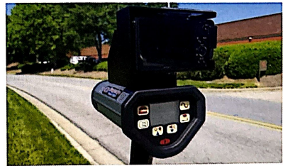
Hình 8. Thiết bị đo vận tốc phương tiện giao thông sử dụng hiệu ứng Doppler.
