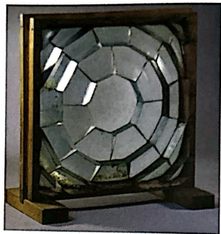
Hình 5. Thấu kính Fresnel thời kì đầu. Do sự hạn chế của công nghệ chế tạo, nhiều khối thủy tinh được ghép với nhau.
