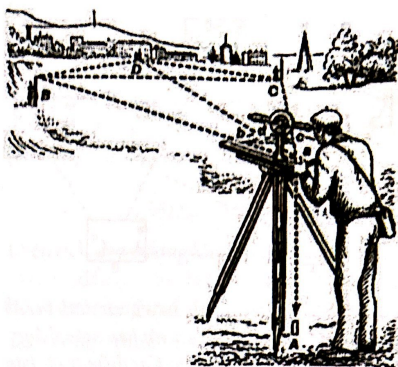
Hình 3. Phương pháp tọa sử dụng bàn mặt phẳng để xác định tọa độ các vị trí từ một điểm cố định.
